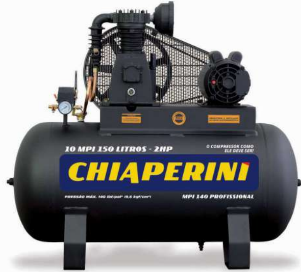
10 MPI - 150L - 2HP - 2P 1 Cilindro Vertical duplo - 2 pistões 1 estágio - 140 lbf/pol 2
